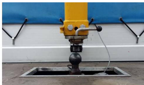
Rys. 9. Widok dyszla naczepy ustawionego w pozycji umożliwiającej sprzężenie z zaczepem kulowym [archiwum PIMR-BE]
