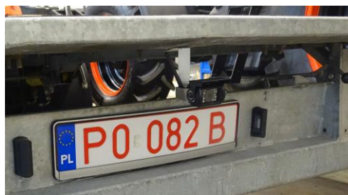
Rys. 10. Widok bezprzewodowej kamery zamocowanej pod rampą naczepy NGS-9,6 [archiwum PIMR-BE]
