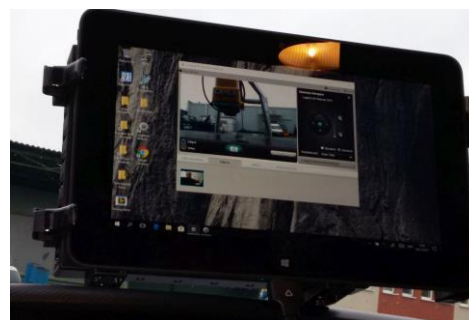
Rys. 5. Widok obrazu na monitorze Dell-Latitude 10-ST2 z kamery Logitech HD Webcam C615 zamocowanej na środkowej burcie skrzyni ładunkowej [archiwum PIMR-BE]
