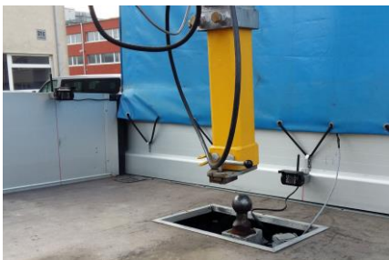
Rys. 6. Widok bezprzewodowych kamer zamocowanych na burtkach skrzyni ładunkowej [archiwum PIMR-BE]
