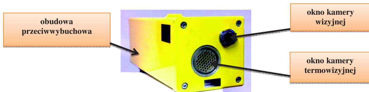
Rys.5. Kamera termowizyjna w obudowie przeciwwybuchowej [5]
