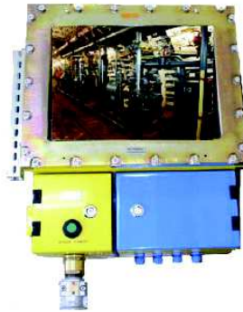
Rys. 6. Komputer w obudowie przeciwybuchowej [4]
