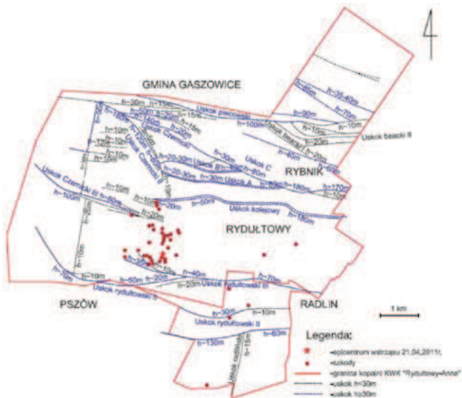
Rys. 4. Lokalizacja szkód górniczych po wstrząsie z dnia 21.04.2011 r. na tle lokalnej tektoniki (na podstawie mat. arch. KWK „Rydułtowy-Anna”)
