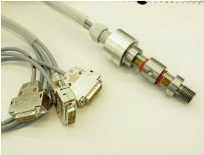
Rys. 1. Sworzień pomiarowy z naklejonymi tensometrami Fig. 1. Measuring bolt with installed strain gauge
