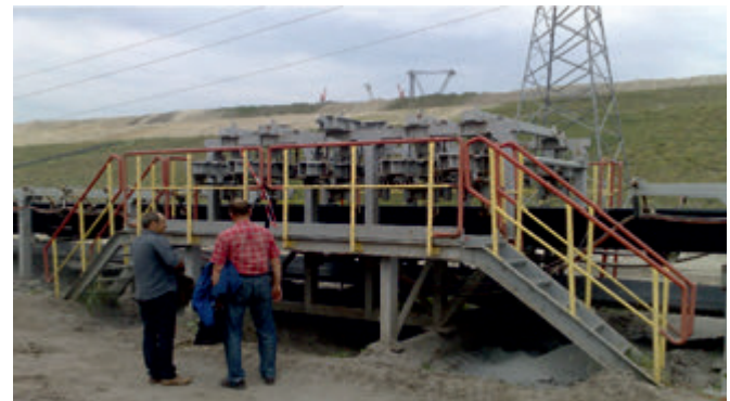
Rys. 6. Człon pomiarowy zamontowany na trasie przenośnika Fig. 6. Measuring unit assembled on construction of conveyor
