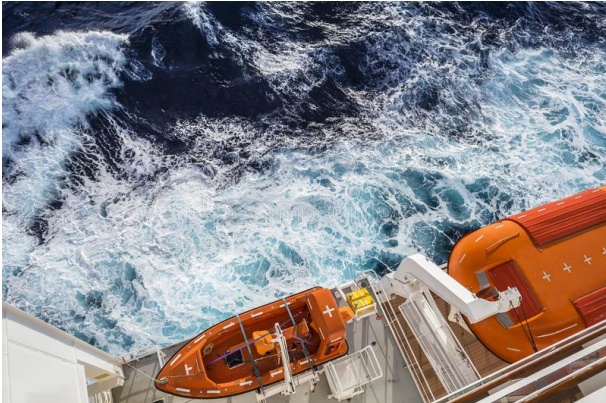
Rys. 4 W realnych warunkach szalupa tworzy duże wahadło, które przy przechyłach z dużą siłą uderza o burtę statku [7]
