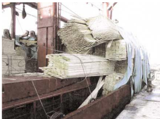
Rys.1. Przechył statku spowodowany przesunięciem się na pokładzie ładunku drewna.[4]
