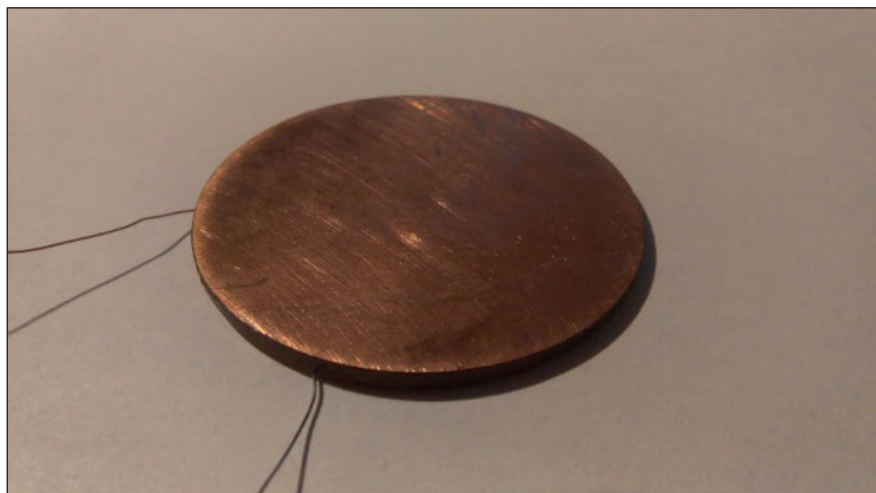
Rys. 13. Kalorymetr zintegrowany z termoparą typu T
