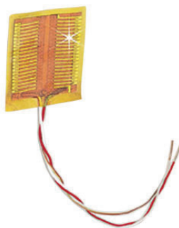
Rys. 14. Widok cienkowarstwowego czujnika gęstości strumienia ciepła HFS
