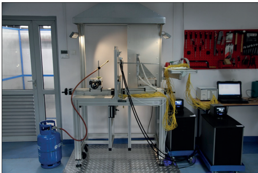
Rys. 2. Stanowisko pomiarowe do badania próbek pakietów materiałowych ubrań ochronnych poddanych oddziaływaniu płomienia
