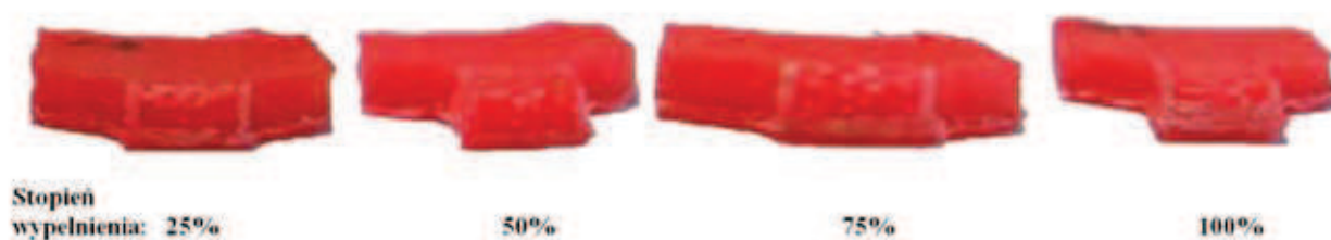
Rys. 8. Przełomy próbek wydrukowanych przy różnym stopniu wypełnienia Fig. 8. Breakthroughs samples printed with different degrees of filling
