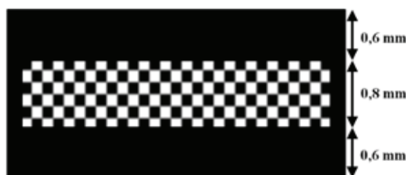
Rys. 4. Schemat przekroju wydrukowanych próbek
