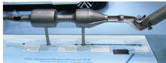
Rys. 6. Komora mieszania oraz pierwsza i druga część reaktora SCR
