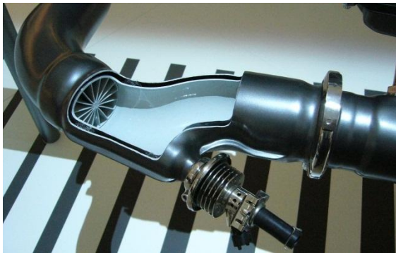
Rys. 4. Komora mieszania z wtryskiwaczem dozującym AdBlue
