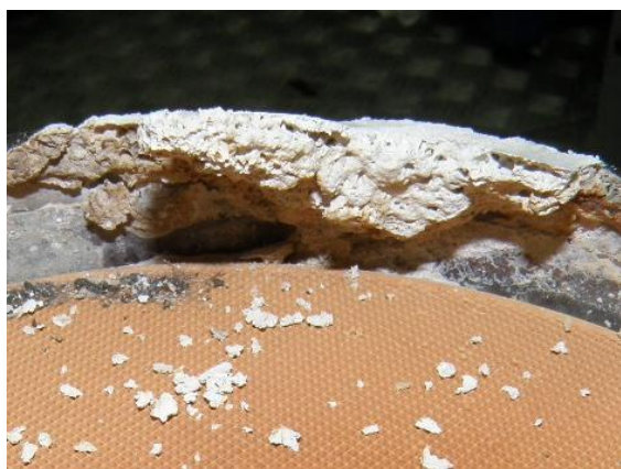
Rys. 12. Osady stałe na powierzchni reaktora SCR podczas testów badawczych w Laboratorium Silników BOSMAL
