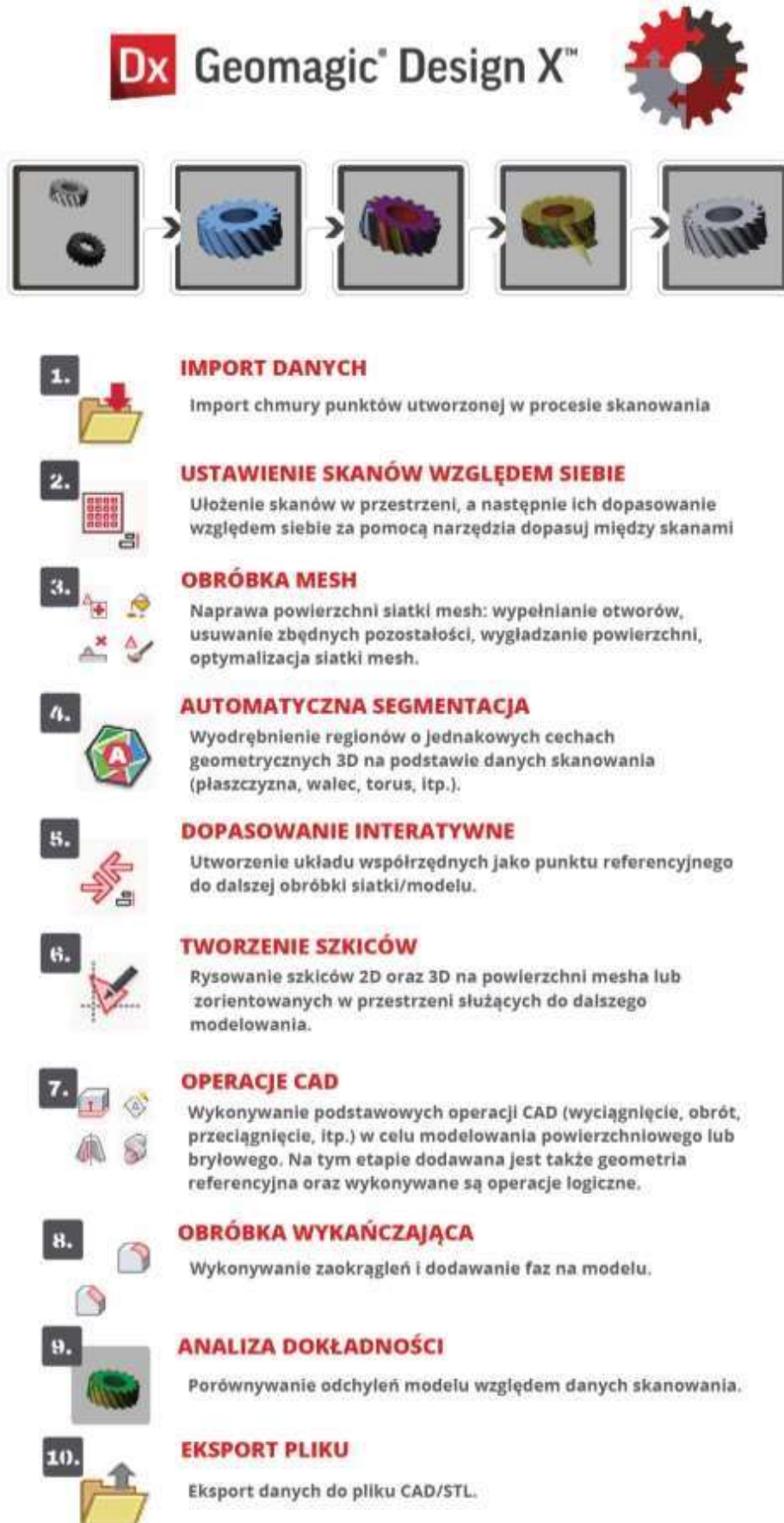
Rys. 3. Schemat postępowania przy tworzeniu modelu bryłowego CAD na podstawie skanu 3D (*.stl)
