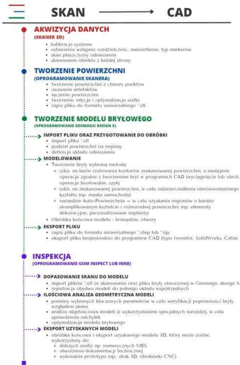
Rys. 2. Procedura inżynierii odwrotnej
