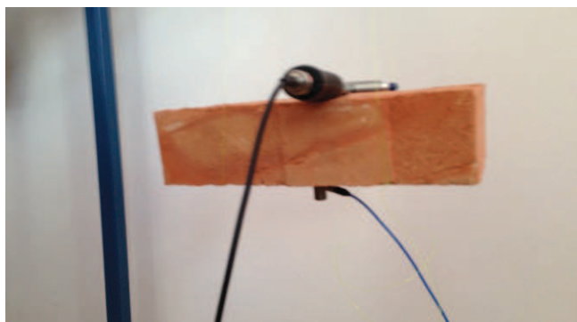
Rys. 7. Widok montażu badanej próbki w czasie wykonywania pomiarów
