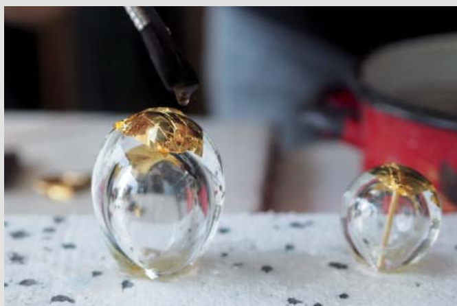
Fot. 14. Złocenie szklanych baniek przed rozdmuchaniem w piecu hutniczym, Wydział Szkła i Ceramiki, ASP Wrocław.
