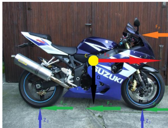
Rys. 1. Siły hamowania na osiach kół motocykla
