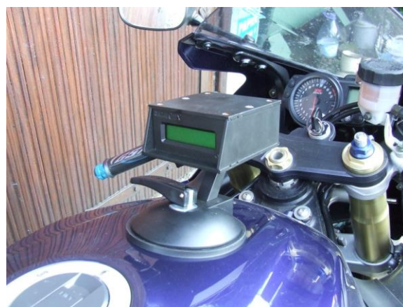
Rys. 7. Miernik zamontowany na baku motocykla
