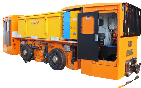
Rys. 7. Lokomotywa akumulatorowa typu DLPA90F produkcji czeskiej [17]
