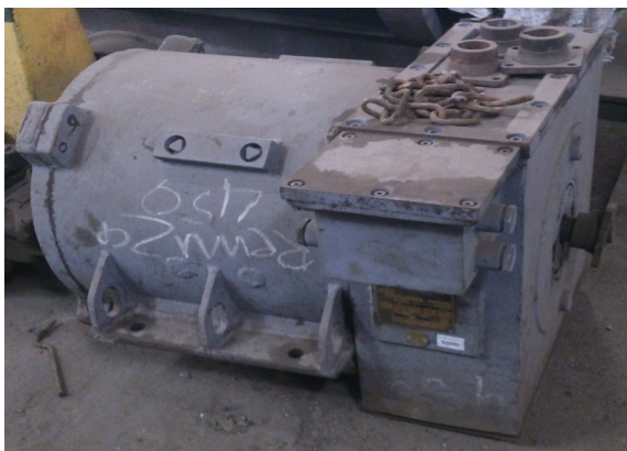
Rys. 5. Silnik prądu stałego typu LDs 327 [13]
