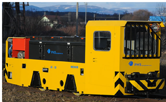
Rys. 6. Lokomotywa akumulatorowa typu AE 30 produkcji słowackiej [18]
