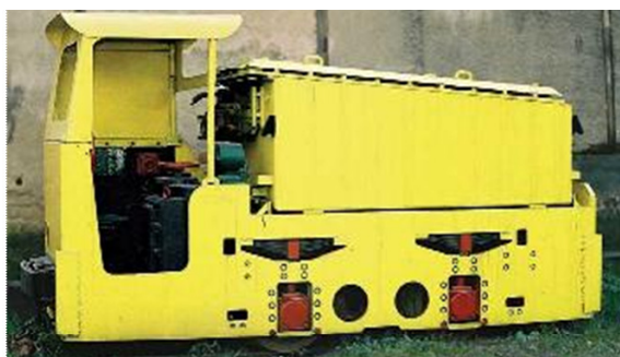
Rys. 1. Lokomotywa akumulatorowa typu Ldag-05 (Karlik) [11]
