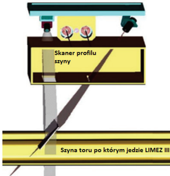
Rys. 16. Jeden z dwóch skanerów profilu szyny do określania osi toru [16]
