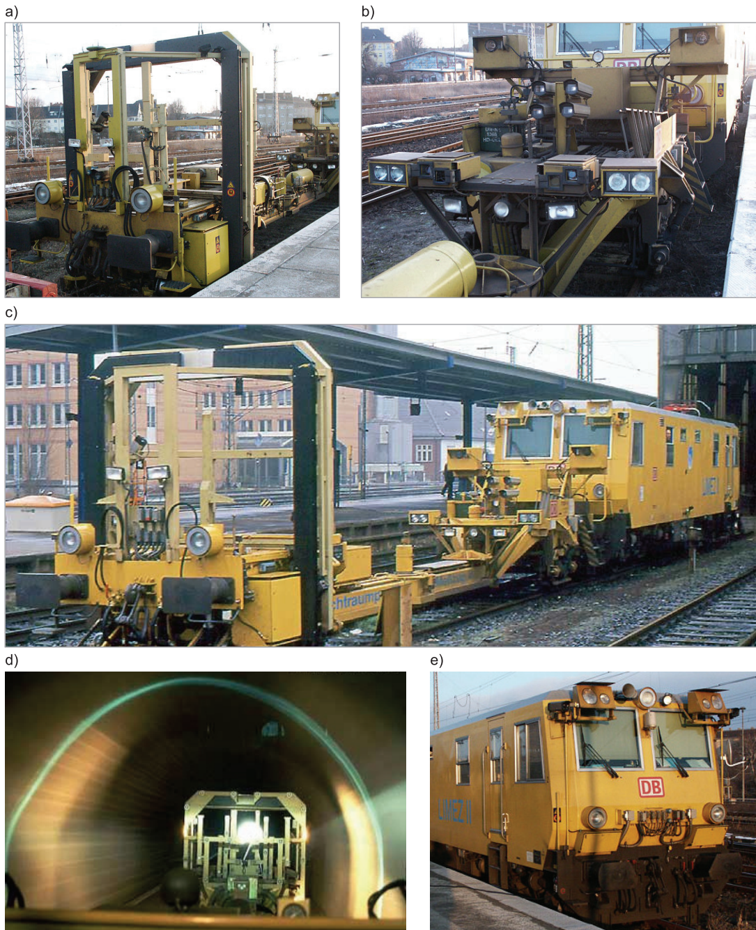
Rys. 8. Zestaw pomiarowy LIMEZ II: a) rama ekranowa wagonu pomiarowego [fot. Thomas Linberg], b) wyposażenie ramy wagonu pomiarowego [fot. Thomas Linberg], c) ogólny widok zestawu pomiarowego LIMEZ II [8], d) pomiar tunelu [14], e) czoło członu napędowego zespołu pomiarowego LIMEZ II [fot. Thomas Linberg]
