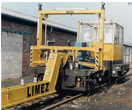
Rys. 7. Pojazd pomiarowy LIMEZ I: a) widok ramy z przyrządami pomiarowymi, b) widok pojazdu [fot. ze zbioru autora]
