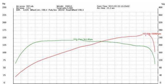
Rys. 6. Wykres seryjnej mocy i momentu obrotowego silnika 1.8T 163HP [2]
