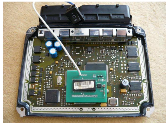
Rys. 5. Sterownik Bosch EDC15P+ z zamontowaną płytką [2]
