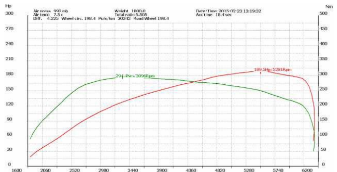
Rys. 7. Wykres mocy i momentu obrotowego silnika 1.8T 163HP po modyfikacji [2]
