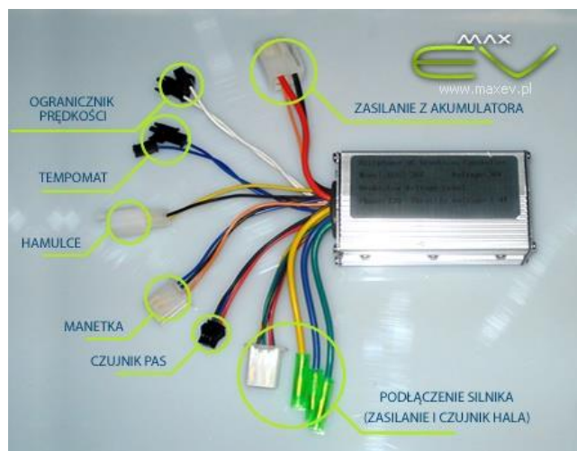
Rys. 12. Kontroler – sterownik model KU62-36V 250W Ecitypower z oznaczonymi połączeniami [41]
