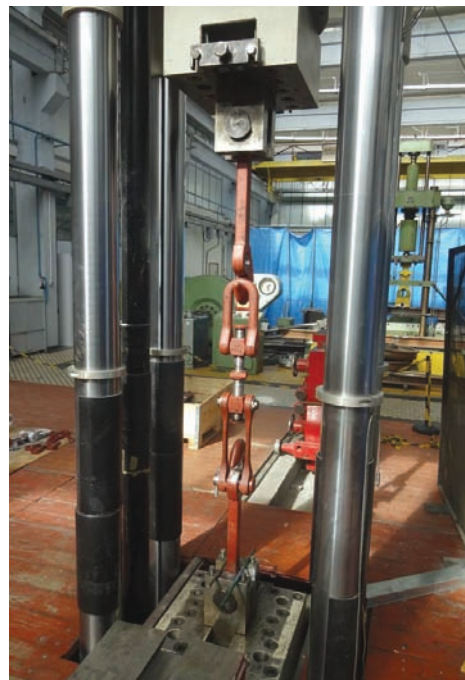
Rys. 2. Sprzęg śrubowy 1 MN podczas badań zmęczeniowych wykonanych maszyną wytrzymałościową LFV [fot. D. Kowalczyk]
