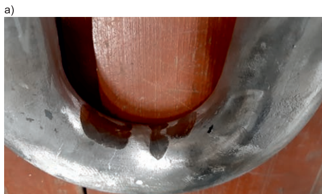
Rys. 5. Widok zużytej powierzchni pałaka sprzęgu spowodowany tarcieniem o hak ciągnący: a) widok z lewej strony, b) widok z prawej strony [fot. D. Kowalczyk]
