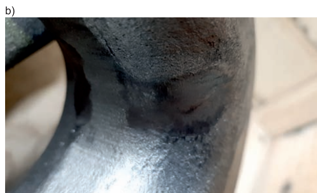
Rys. 5. Widok zużytej powierzchni pałaka sprzęgu spowodowany tarcieniem o hak ciągnący: a) widok z lewej strony, b) widok z prawej strony [fot. D. Kowalczyk]
