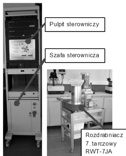
Rys.2. Stanowisko badań dokładności rozdrabniania liści mięty pieprzowej: rozdrabniacz siedmiotarczowy RWT-7JA, pulpit i szafa sterownicza z systemem LabVIEW
