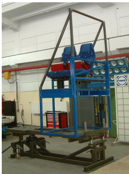
Rys. 7. Pojedyncza platforma przechylająca z dodatkowo obciążonym siedzeniem [6] i wycinkiem struktury nośnej pojazdu
