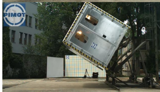
Rys. 8. Połączone ze sobą dwie platformy przechylające podczas badania kontenera medycznego, zamontowanego na konstrukcji zastępczej
