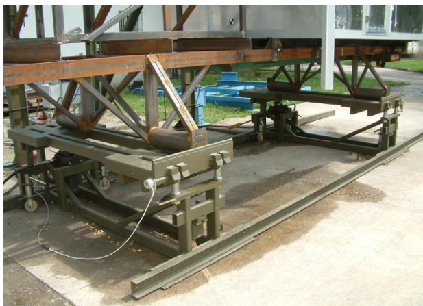
Rys. 8. Połączone ze sobą dwie platformy przechylające podczas badania kontenera medycznego, zamontowanego na konstrukcji zastępczej
