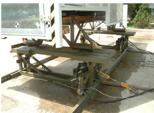
Rys. 9. Połączone ze sobą dwie platformy przechylające podczas badania kontenera medycznego z elementami mocującymi do podłoża
