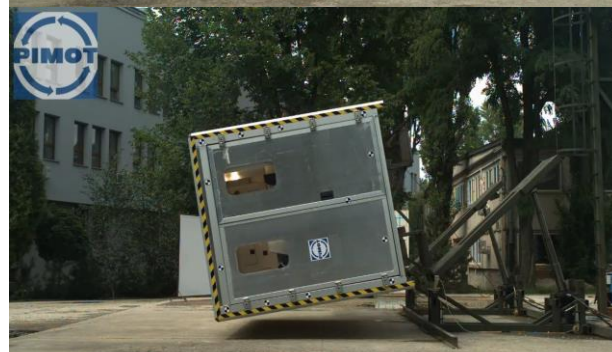
Rys. 9. Połączone ze sobą dwie platformy przechylające podczas badania kontenera medycznego z elementami mocującymi do podłoża
