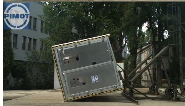
Rys. 11. Kontener medyczny podczas próby przewracania zgodnie z Regulaminem EKG ONZ nr 66 i Normą DIN 13500
