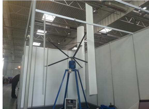
Rys. 6. Widok małej elektrowni VAWT z opracowanym generatorem (targi ENERGETICS w Lublinie 2012 rok)
