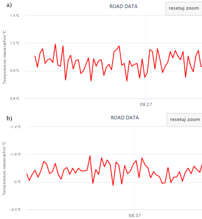
Rys. 6. Przebieg czasowy temperatury jezdni dla testu stacjonarnego przeprowadzonego w ciągu dnia a) jezdni suchej b) jezdni pokrytej śniegiem
