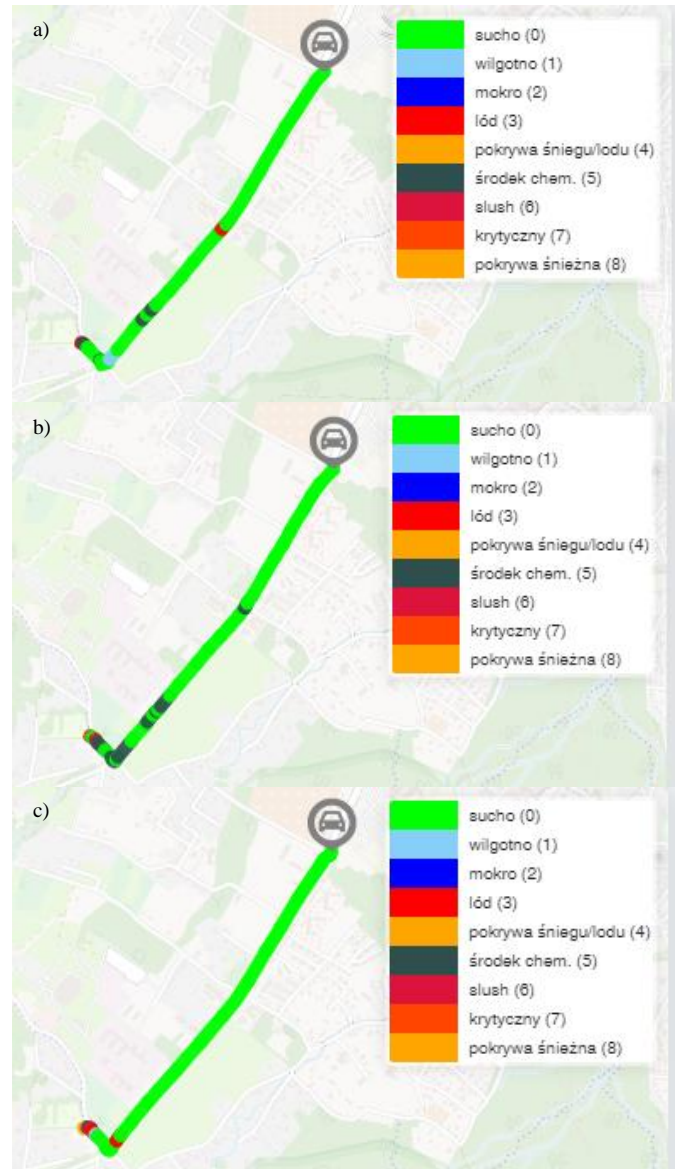
Rys. 12. Odczyt stanu nawierzchni dla przejazdów z różnymi prędkościami a) 30 km/h b) 45 km/h c) 60 km/h
