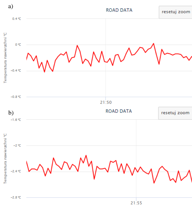
Rys. 7. Przebieg czasowy temperatury jezdni dla testu stacjonarnego przeprowadzonego w ciągu nocy a) jezdni suchej b) jezdni pokrytej śniegiem
