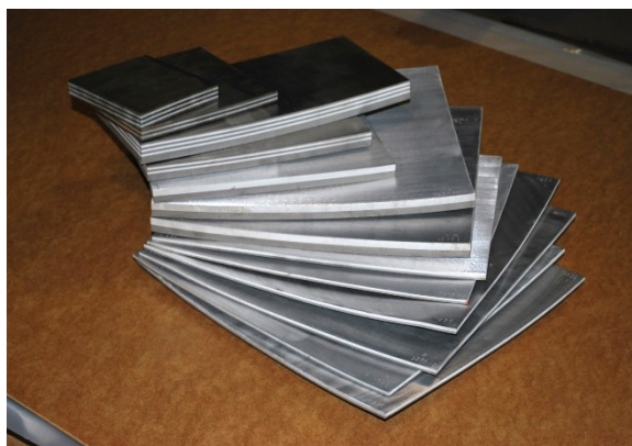
Rys. 3. Partia wykonanych płyt próbnych Ti6Al4V/AA2519
