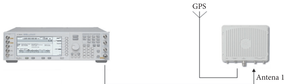
Rys. 3. Schemat pomiarowy — pomiar czułości stycznej CW
