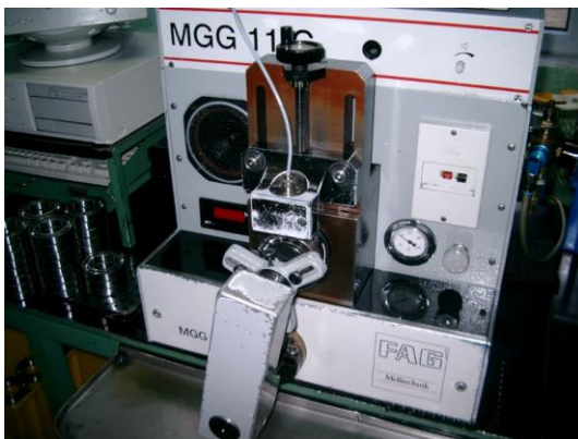
Rys.8 Wibrometr MGG11 przeznaczony do badań drgań łożysk
