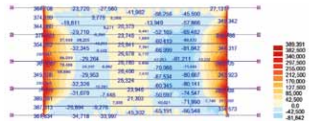
Rys. 9. Siły membranowe na kierunku poprzecznym – N_{YY} (kN) w wariantcie 1 dla przykładowej kombinacji obciążeń, uwzględniającej obciążenie: stałe, użytkowe, skurczem betonu i nierównomierne śniegiem
