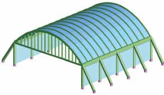
Rys. 7. Schemat modelu segmentu A powłoki walcowej uźebrowanej (wariant obliczeniowy nr 1)
