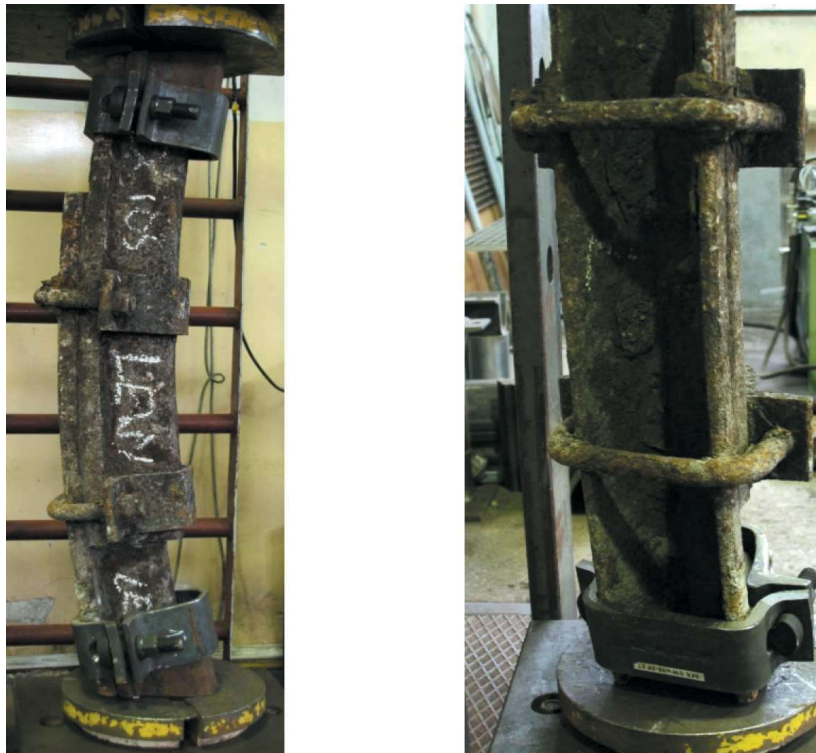
Rys. 3. Złącze cierne 1 przygotowane do badań i stan techniczny strzemiön
