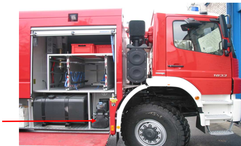
Fot. 8. Dodatkowy zbiornik AdBlue (silnik Mercedes z systemem SCR)
