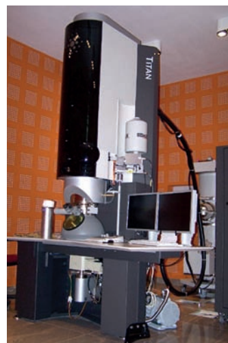
Rys. 1. Mikroskop S/TEM TITAN 80-300 firmy FEI zainstalowany w 2012 roku w Laboratorium Badania Materiałów Inżynierskich i Biomedycznych
