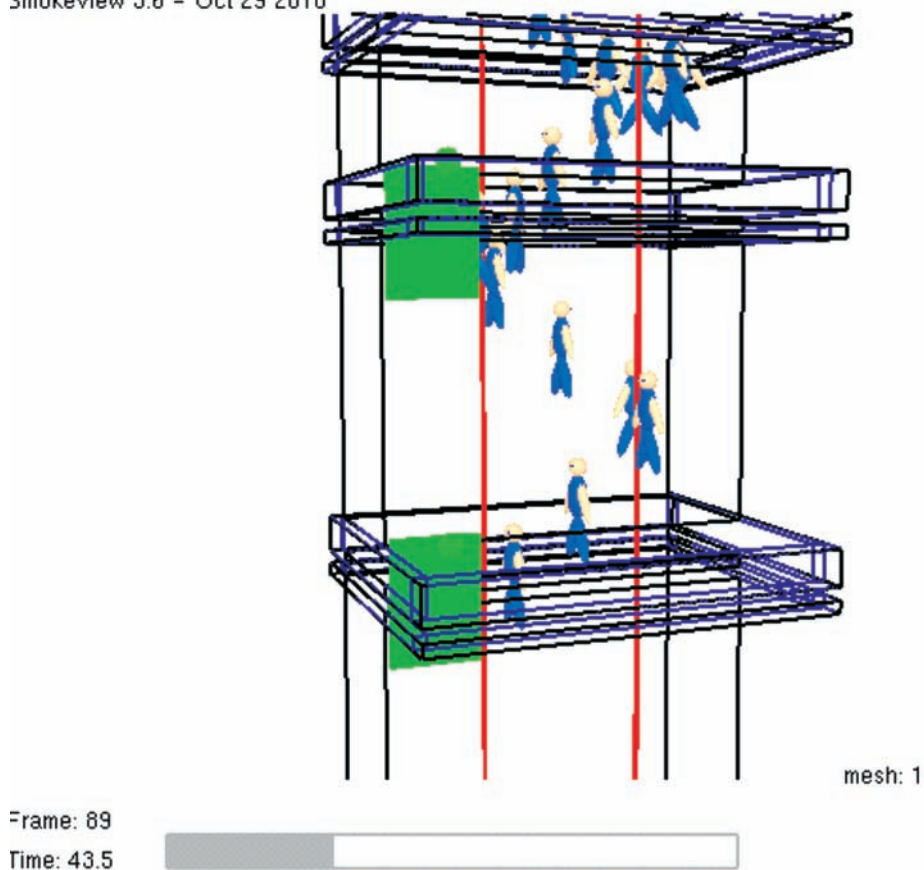
Rys. 10. Symulacja ewakuacji klatką schodową
