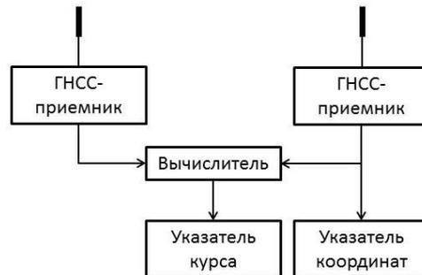
Рис. 2. Конфигурация спутникового компаса
