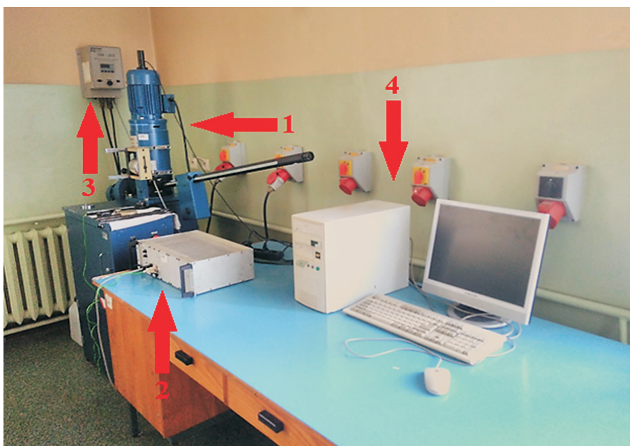
Rys. 3. Aparat czterokulowy T-02 wraz z oprzyrządowaniem: 1 — aparat czterokulowy T-02, 2 — mikroprocesorowy sterownik tribologiczny, 3 — regulator SM-303, 4 — komputer z programem sterującym
