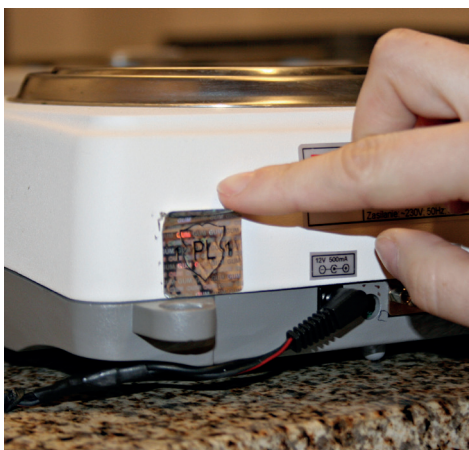
Nakładanie cechy zabezpieczającej na śrubie zabezpieczającej dostęp do elementów regulacji wagi oraz świadectwo legalizacji ponownej wagi wystawione przez Naczelnika Obw. UM w Warszawie
