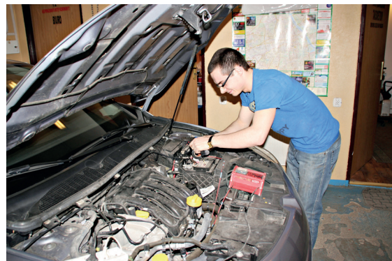
Montaż taksometru w pojeździe
