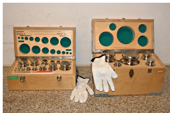
Wzorce masy ze stali nierdzewnej niemagnetycznej stosowane do sprawdzania wag kl. III o obciążeniu max. do 15 kg
