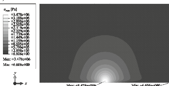
Rys. 5. Plany warstwiczne maksymalnych naprężeń rozciągających ( h=20\text{cm}, k = 10 \times 10^6 \text{ N/m}^3 ). Obciążenie w środku boku.. a) Podłoże na całości płyty, b) Największy ubytek podłoża.
