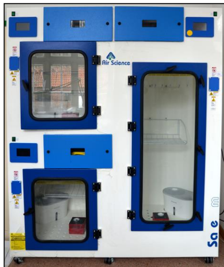
Rysunek 46. Komora cyanoakrylowa Model Safefume CATRI firmy Air Science z USA. Zbudowana z trzech oddzielnych komór z niezależnym systemem sterowania oraz bezkanałowym system filtrów węglowych
