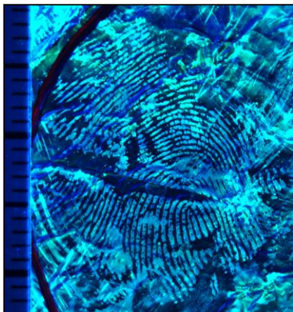
Rysunek 35. Odzworowanie linii papilarnych w kilkakrotnym powiększeniu ujawnione Ardroxem P133D sfotografowane w świetle ultrafioletowym. Źródło – opracowanie własne
