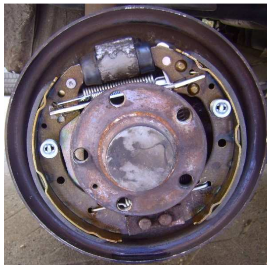
Fot. 2. Hamulec promieniowy hydrauliczny – szczękowy.
