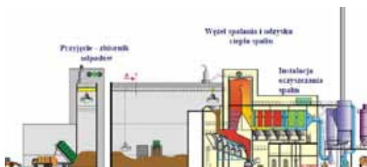
Rys. 4. Schemat spalarni odpadów komunalnych w technologii rusztowej
