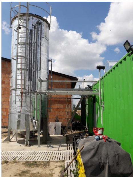
Rys. 1. Reaktor przepływowy monosubstratowy do fermentacji metanowej gnojowicy wraz z instalacją do produkcji biogazu [foto G. Wałowski]
