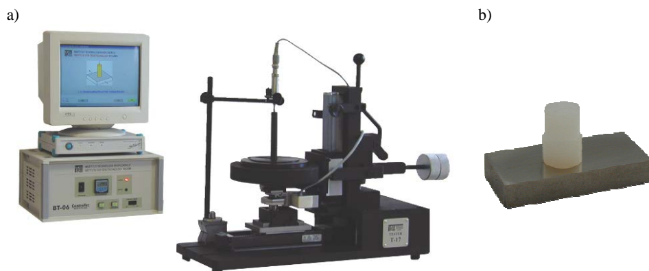
Rys. 1. Stanowisko badawcze: a) tribotester T-17, b) próbka i przeciwpróbka Fig. 1. Research stand: a) tribotester T-17, b) samples
