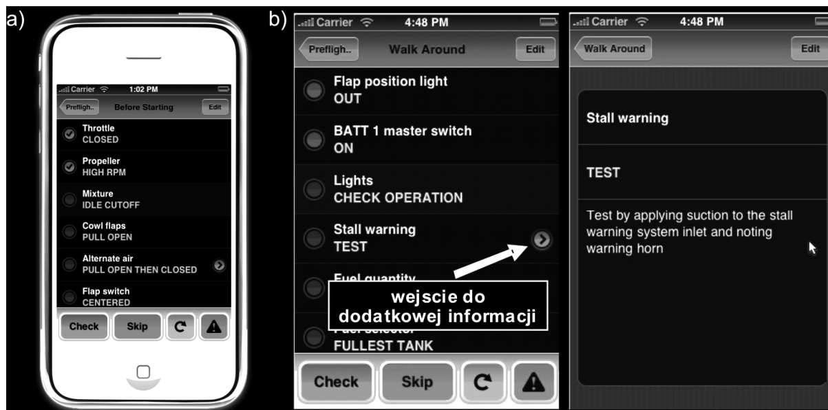
Rys.4. Narzędzie ForeFlight's Checklist Pro: a) ekran tworzenia listy kontrolnej, b) ekran przeglądania listy kontrolnej z opcją przypisaną notatki [18]
