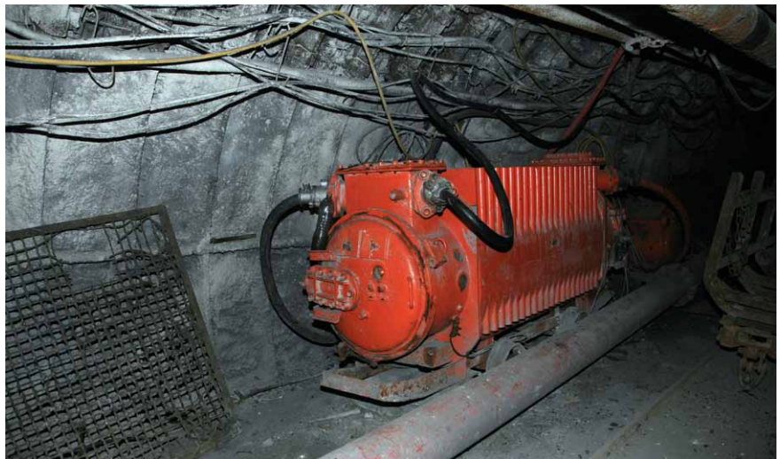
Ognioszczelna stacja transformatorowa IT3Sb 6 kV na 500 V
