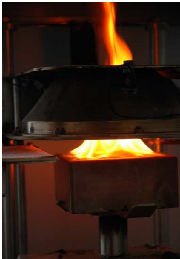
Rys. 3. Sposób umieszczenia próbki w komorze spalania kalorymetru
