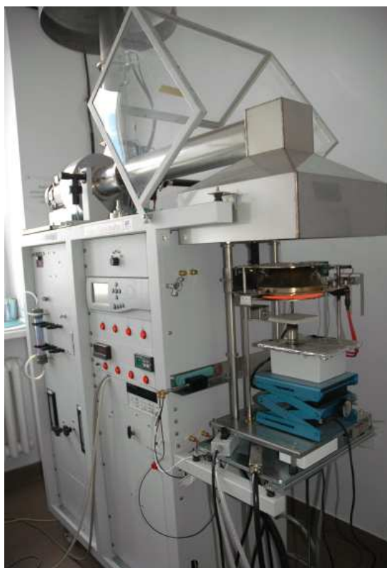
Rys. 2. Kalorymetr stożkowy znajdujący się w Pracowni Zakładu Spalania i Teorii Pożarów w Szkole Głównej Służby Pożarniczej
