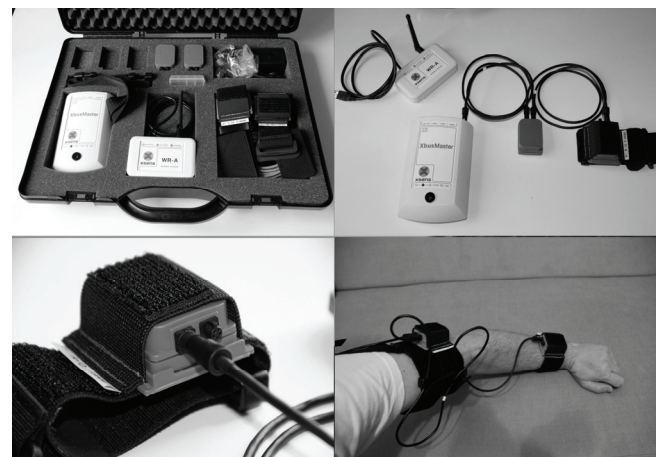
Rys. 1. System rejestracji ruchu Xsens Xbus Kit z dwoma czujnikami MTx Fig. 1. Xsens Xbus Kit motion capture system with two MTx sensors
