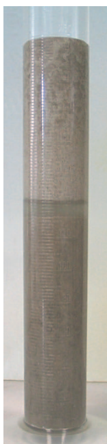
Fot. 1. Nadmierne frakcjonowanie cząstek zaczynu cementowego
