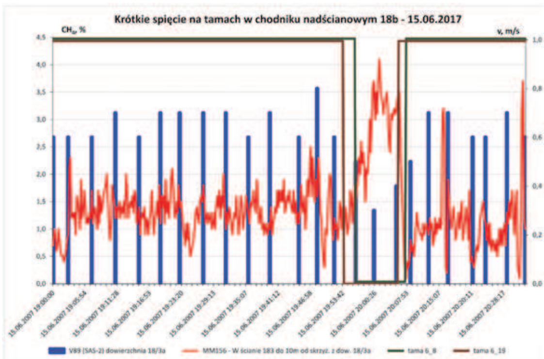
Rys. 3. Zmiany prędkości powietrza i stężenia metanu MM156 w okresie krótkich spięć Fig. 3. Changes in air velocity and concentration of methane MM156 during short circuits
