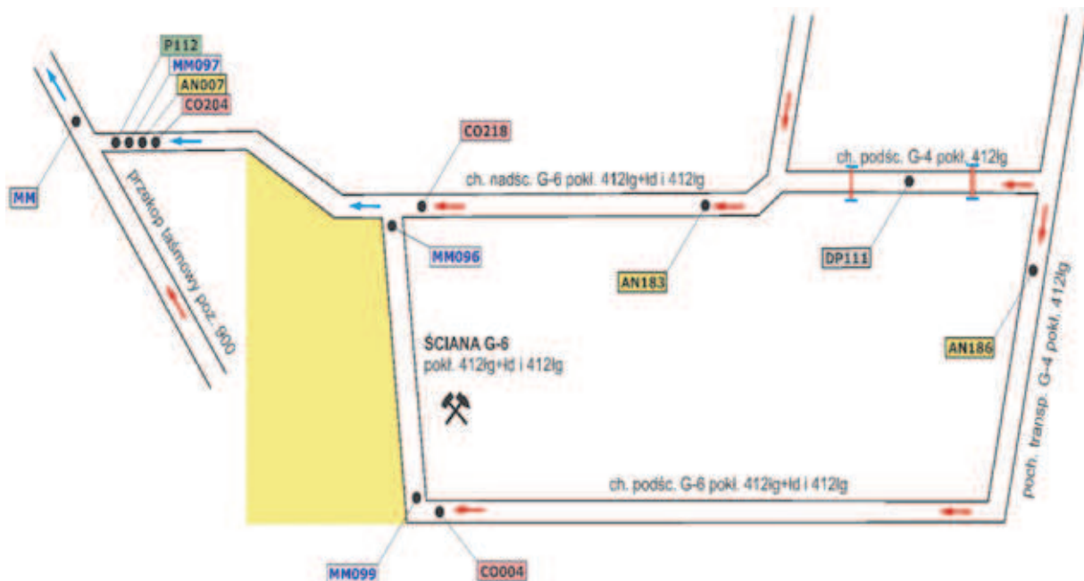
Rys. 8. Schemat przewietrzania i rozmieszczenia czujników w rejonie ściany G-6 pokład 412lg+1d Fig. 8. Diagram of ventilation and location of sensors in the area of longwall G-6, seam no. 412lg+1d
