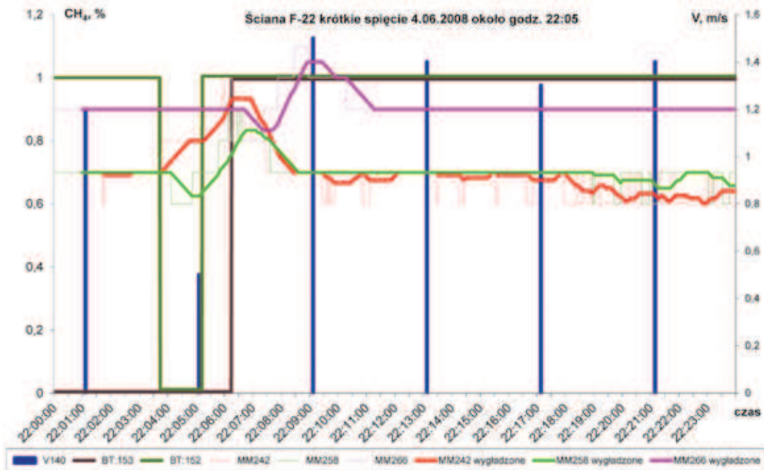
Rys. 7. Zmiany stężenia metanu w rejonie ściany F-22 w wyniku krótkiego spięcia Fig. 7. Changes in the concentration of methane in the area of longwall F-22 as a result of a short circuit
