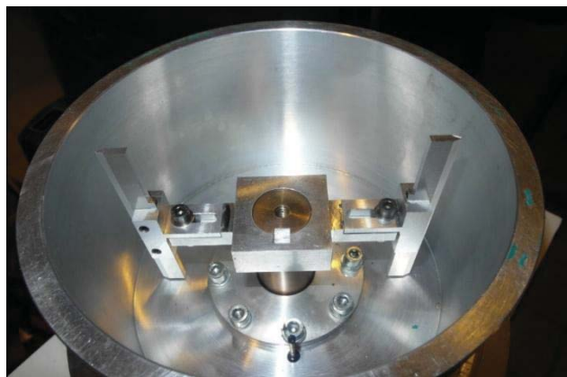
Rys. 4. Cylinder wraz z układem łopatek skrobiących
