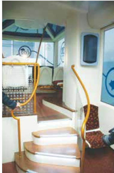
Wejście na podniesiony podest części pasażerskiej, adresowanej do pasażerów pokonujących dalsze odległości
