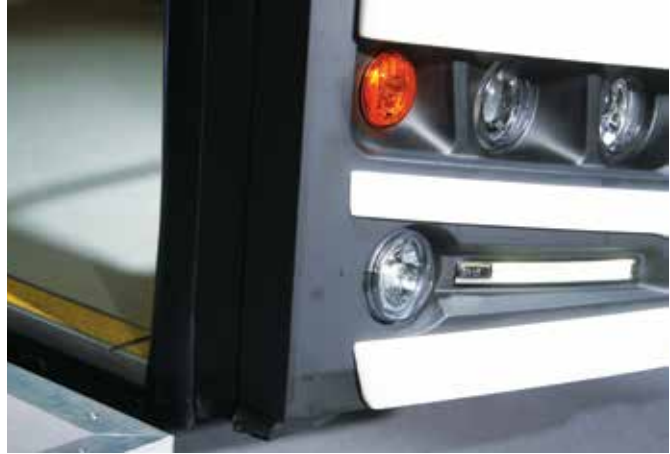
Nowe reflektory LED zabudowane w Solarisie newUrbino
