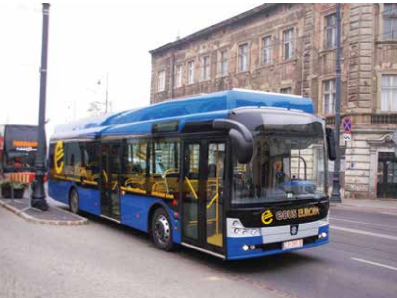
W pełni elektryczny Solbus Solcity 12, napędzany za pomocą ogniw paliwowych
