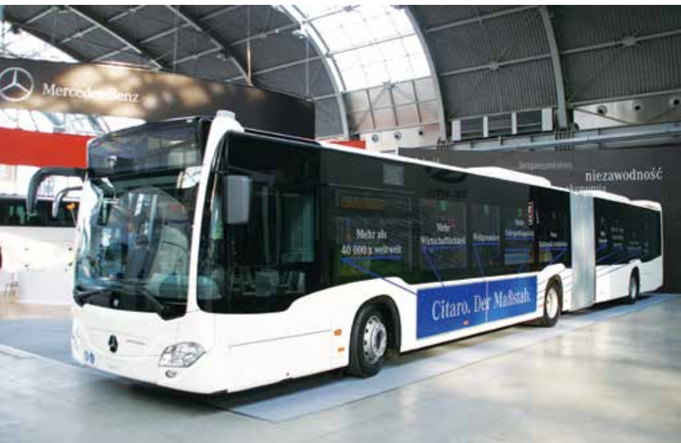
Nowy Mercedes Citaro II w wersji przegubowej, wyposażony w mały silnik o pojemności 7,7 dm 3
