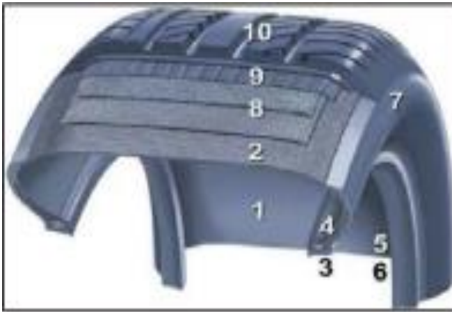
Rys. 1. Fragment opony radialnej z zaznaczonymi elementami dotyczącymi budowy:
