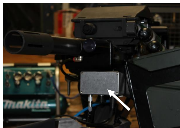
Fot. 5. Widok obudowy płyty głównej elektroniki symulatora.
