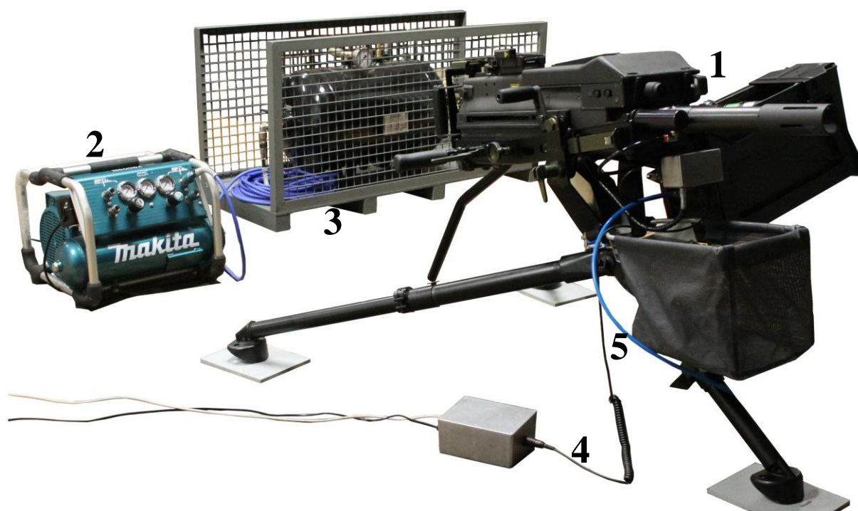
Fot.1. Symulator stanowiska ogniowego 40 mm granatnika automatycznego MK-19 "TRYTON": 1) symulator 40 mm granatnika automatycznego MK-19, 2) kompresor, zbiornik 3) "magazyn ciśnienia", 4) przewód sygnałowo - zasilający łączący granatnik z systemem komputerowym, 5) przewód gazowy,
