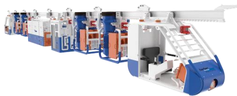
Rys. 4. Ciągnik akumulatorowy typu CA-190 z baterią typu VOLTER
