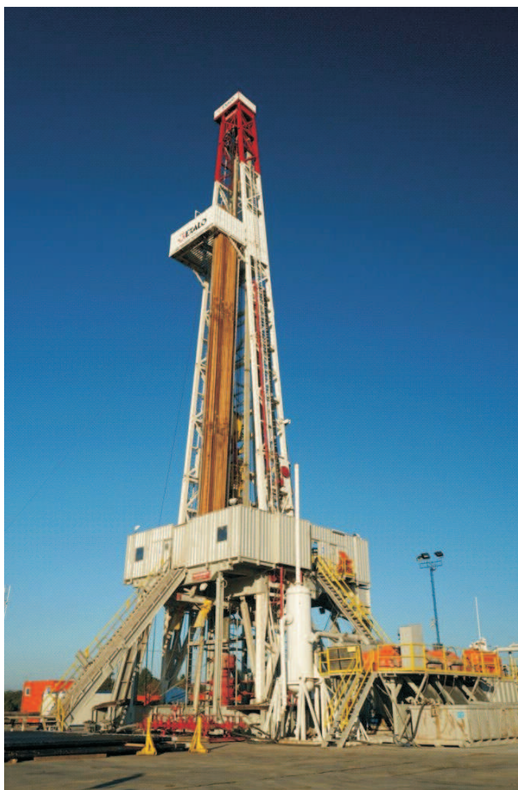
Rys. 1. Wieża wiertnicza podczas wiercenia otworu za gazem z łupków (fot. A Starzycka)
