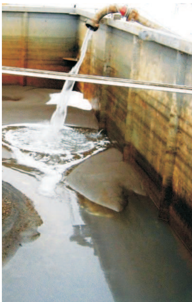
Rys. 4. Płyn zwrotny po zabiegu szczelinowania hydraulicznego (fot. A. Starzycka)
